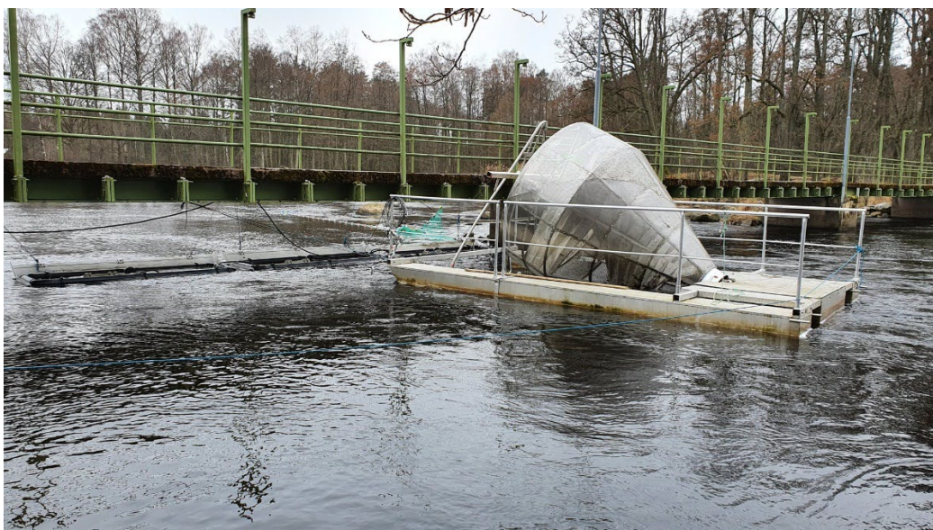
Figur 2. Smolthjulet i uppfällt läge, placerat vid mynningen vid Stora Åråsforsen. Foto: Anna Hagelin.
