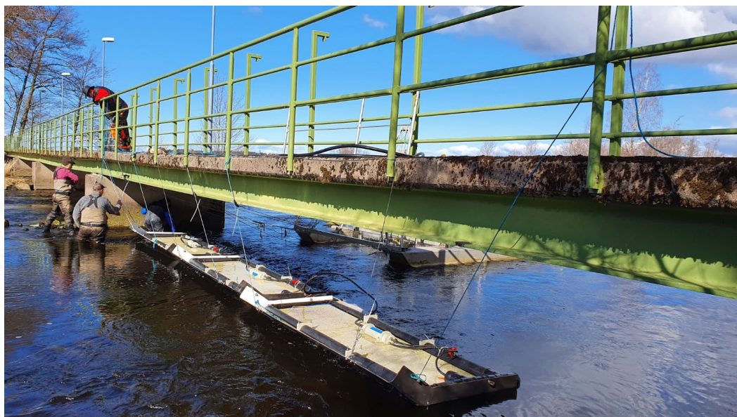
Figur 3. Montering av flytande PIT tag antenner från Biomark vid Stora Åråsforsen 2022. Foto: Anna Hagelin.
