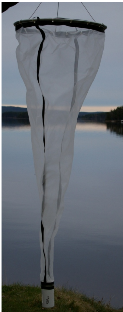
Figur 2. Bilden visar den stora håv som användes vid provtagningen 2016.
