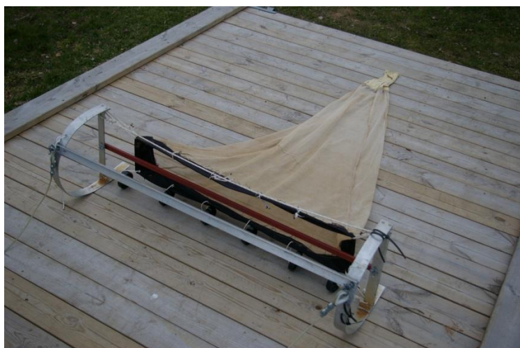
Figur 2. Bilderna visar de två redskap som användes under undersökningarna av glacialrelikta kräftdjur i Väner och Vättern 2011. Till vänster syns mysistrål som användes under dagtid och till höger den stora håv som användes i mörker nattetid.
