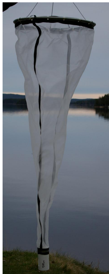
Figur 2. Bilderna visar de två redskap som användes under undersökningarna av glacialrelikta kräftdjur i Väner och Vättern 2011. Till vänster syns mysistrål som användes under dagtid och till höger den stora håv som användes i mörker nattetid.
