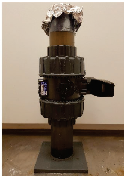
Figur 3. Ett torrt mortlat sedimentprov från Hammarösjön, Vänern (vä), och separertratten (hö) fylld med sediment och zincklorid ( \approx 1.6 \text{ g/mL} ). När bollvalvet stängs kan mikroplasterna som flyter i den övre delen separeras från sedimentet på botten.
