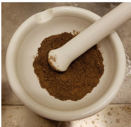
Figur 3. Ett torrt mortlat sedimentprov från Hammarösjön, Vänern (vä), och separertratten (hö) fylld med sediment och zincklorid ( \approx 1.6 \text{ g/mL} ). När bollvalvet stängs kan mikroplasterna som flyter i den övre delen separeras från sedimentet på botten.
