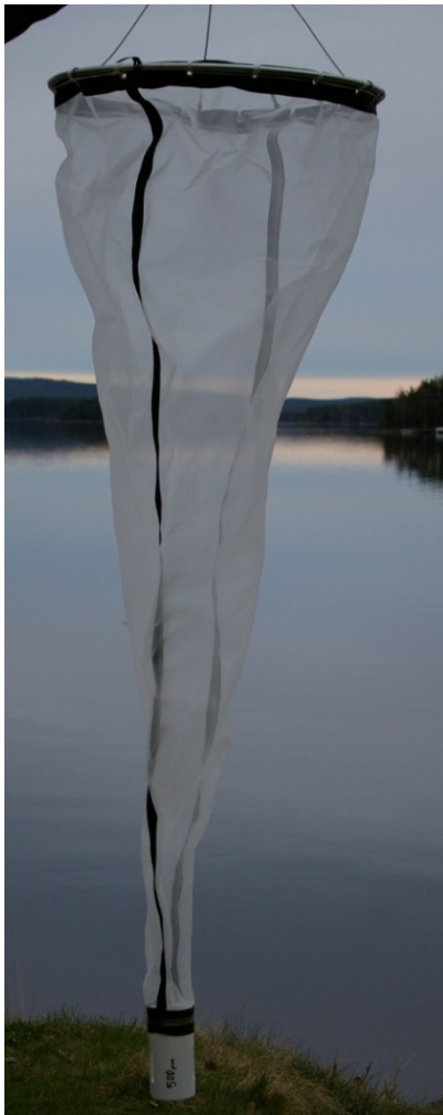
Figur 2. Bilden visar den stora håv som användes vid provtagningen 2017.
